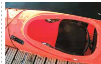
▲ På Jura er strammingen av ryggstøtten flyttet frem til lårstøttene.
